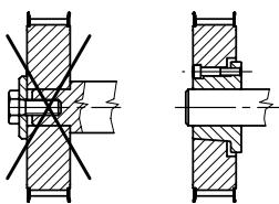
**2) Qualora vi siano movimenti di rotazione soggetti a brusche e frequenti inversioni di moto, la bussola conica evita, per effetto del bloccaggio che genera sull'albero, lo schiavettamento e la tranciatura della chiaffetta di trascinamento.**
